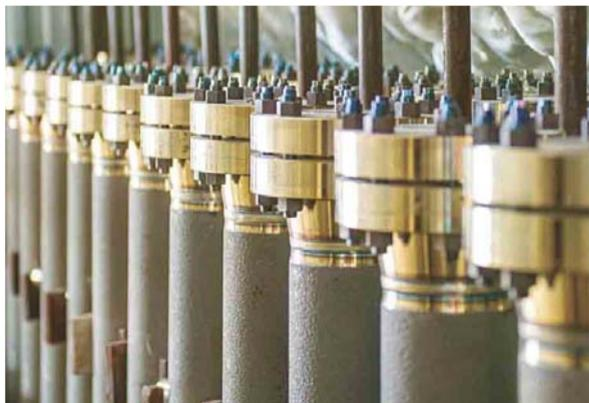
Новые реакционные трубы установлены на печи конверсии П-101/2
