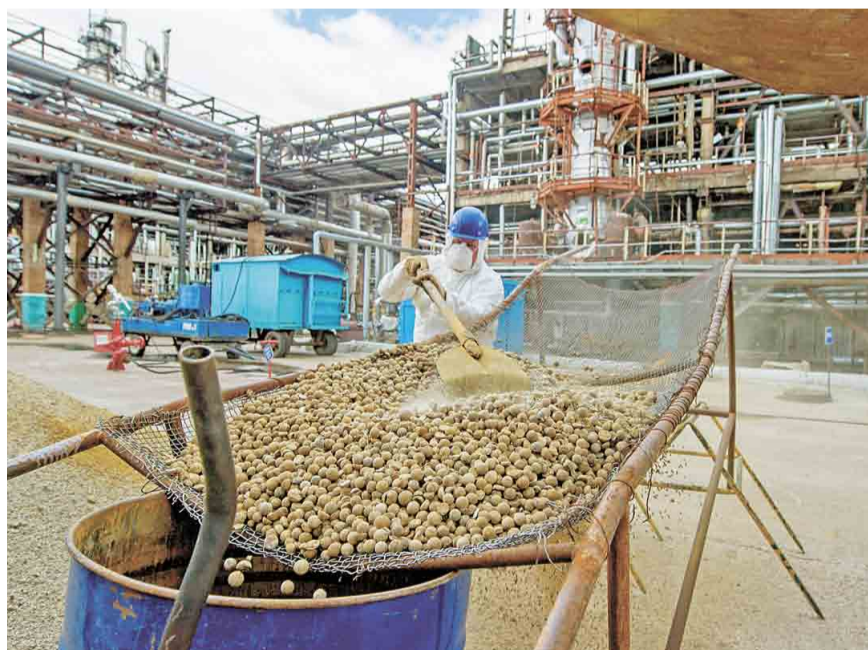
Идет выгрузка отработанного адсорбента из осушителей сжиженных продуктов пиролиза
