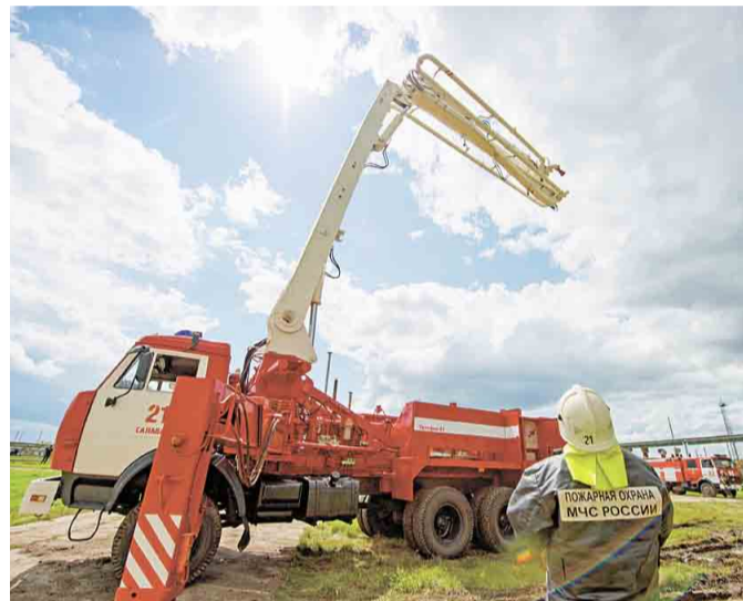
Для локализации пожара использовали пену. Она подавалась с 20-метровой высоты
