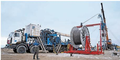
На Ямбургском месторождении приступили к техническому перевооружению газовых скважин с использованием концентрических лифтовых колонн (КЛК). Данная технология позволяет бороться со скоплениями жидкости и механических примесей в забое и в насосно-компрессорных трубах. В этом году в рамках реконструкции на эксплуатацию с применением КЛК переведут 26 скважин.
