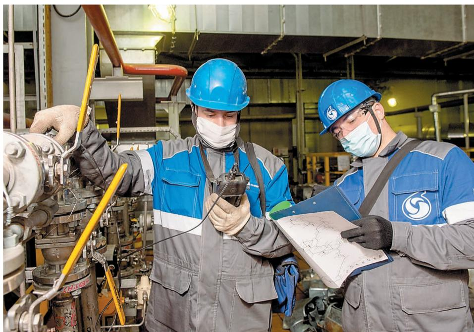
Дефектоскописты ЦПД и НК выполняют ультразвуковую толщинометрию технологического трубопровода
