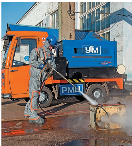
Гидромеханическая чистка оборудования аппаратом высокого давления
