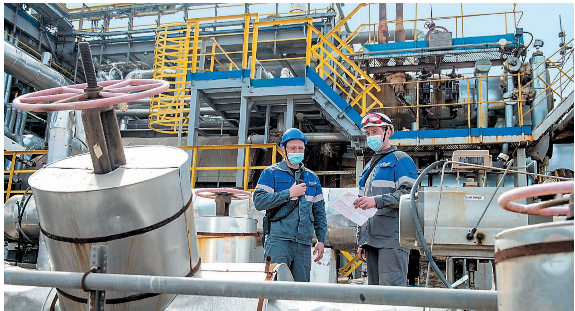
Сотрудники на производстве элементарной серы. В данное время в компании завершается строительство новой установки производства серы. В дальнейшем оба производства будут очищать весь сероводородсодержащий газ, образующийся на промышленной площадке
