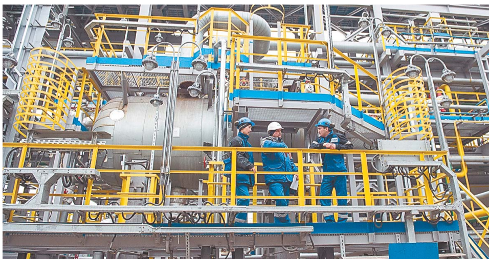
Процесс короткоциклового адсорбции позволяет получить чистый водород для нужд производства
