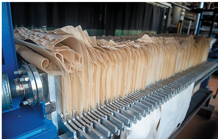
Пресс-фильтр для очистки и получения товарного пластификатора ДОФ
