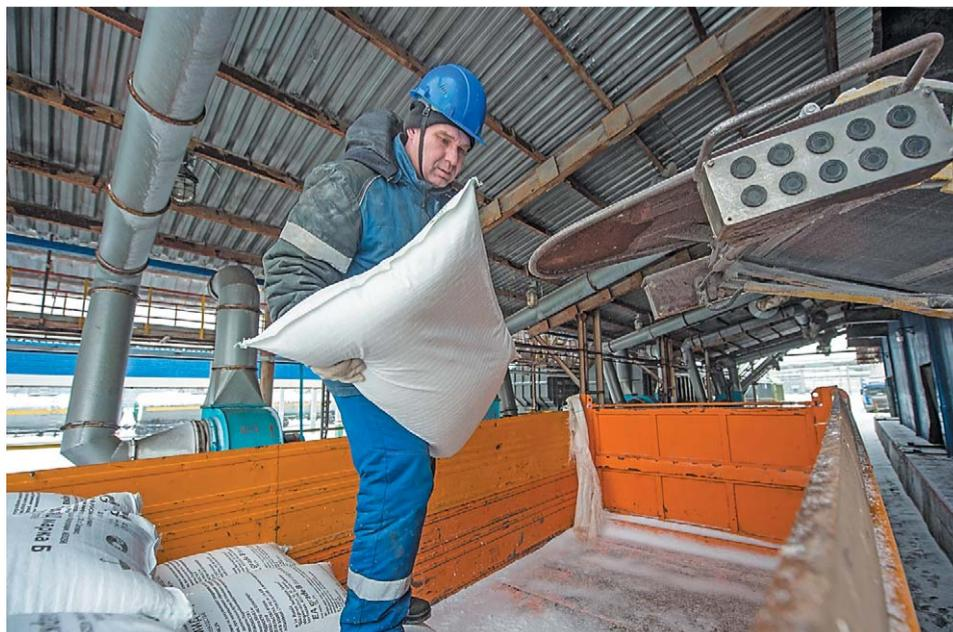
В компании «Газпром нефтехим Салават» карбамид марок А и Б согласно ГОСТ 2081-2010 производят в цехах 24 и 50 ГХЗ. На 2018 год запланировано производство 656 тыс. т прилированного и гранулированного карбамида
