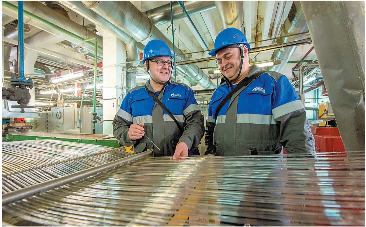
Из экструдера полистирол выходит в виде стренг – своеобразных нитей, которые потом измельчаются до гранул
