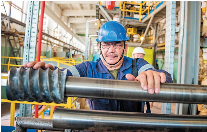
ТОРО даст возможность определять экономическую целесообразность ремонта оборудования. На снимке: сборка шнековых секций валов гранулятора в цехе № 23
