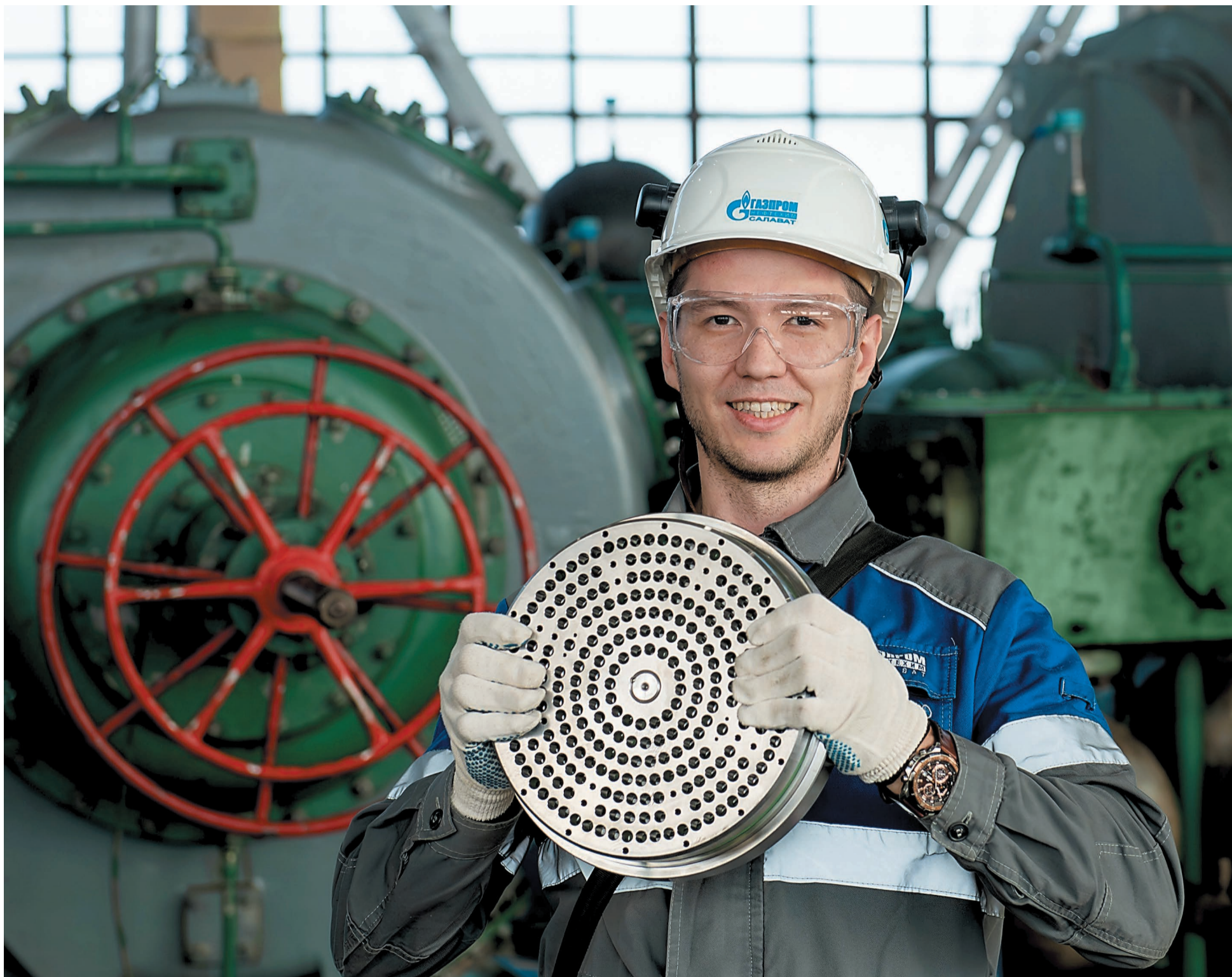
Марат Каримов, инженер-механик установки компрессии цеха № 50, ведет осмотр нового клапана нагнетания 1 ступени
