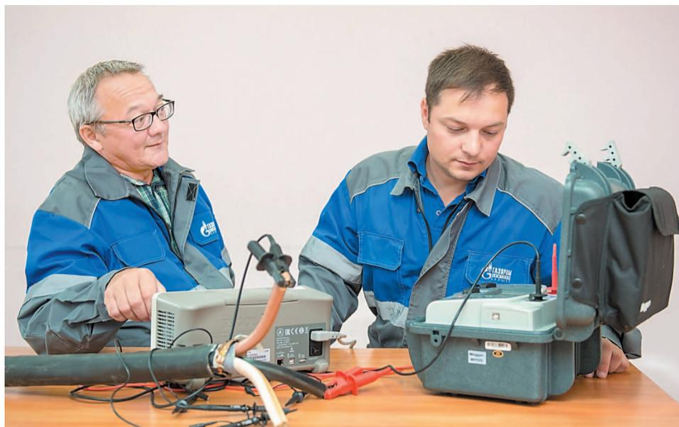
Ведется измерение новых диагностических параметров – коэффициента поляризации и диэлектрического отклика (метод возвратного напряжения)
