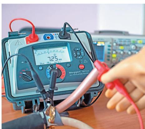
Прибор последнего поколения. Применяется для измерения изоляционных свойств кабеля Megger MIT 525
