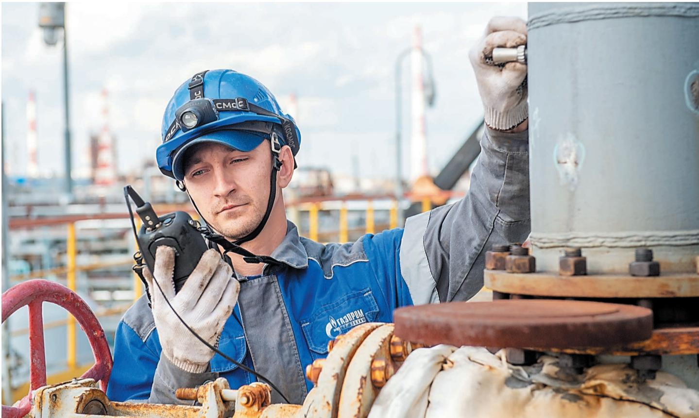
Ультразвуковая толщинометрия на установке ЭЛОУ АВТ-6
