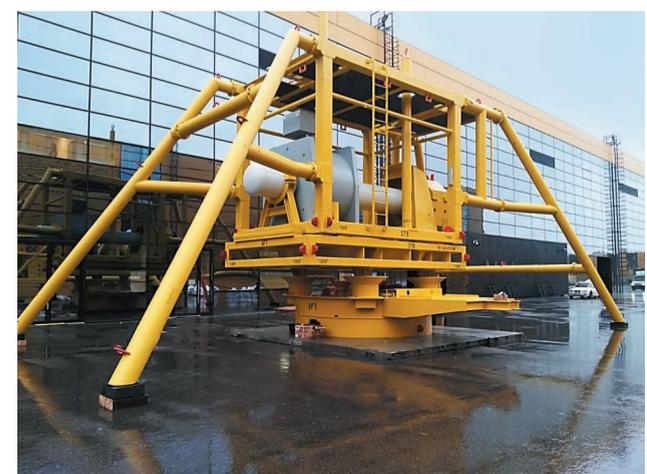
Оконечное устройство трубопровода служит для присоединения линейных трубопроводов к оборудованию системы подводной добычи. Является основой для подключения промысловых или магистральных труб через соединительные секции к основному оборудованию. Вес опытного образца – около 70 тонн
