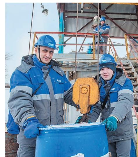
Аппаратчики опытного производства Павел Кравцов, Рамиль Махмутов, Найль Хисматуллин производят загрузку реагентов в реактор
