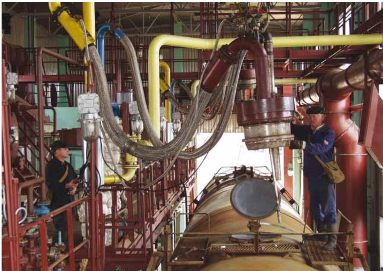
*Устройство герметизации люков при пропарке*
