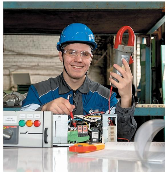
Проверка целостности электрической цепи выкатного модуля
