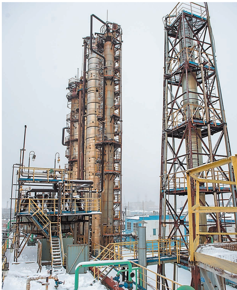
Установка ректификации спиртов C_8 , где происходит выделение 2-этилгексанольной фракции
