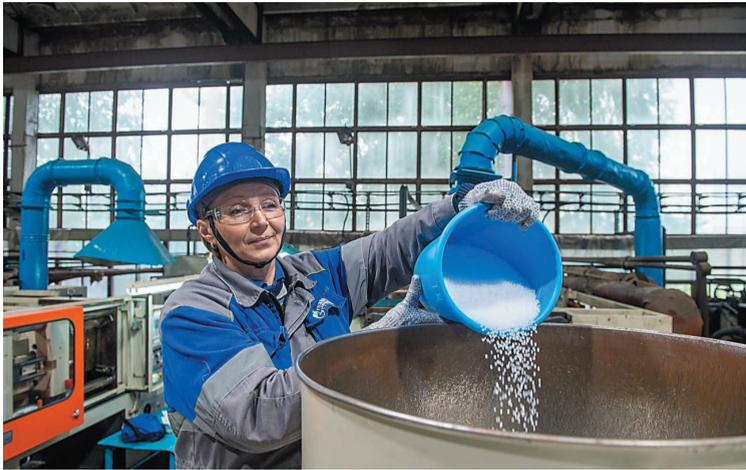
В качестве сырья на установке используется полиэтилен высокого давления, полиэтилен низкого давления, ударопрочный полистирол
