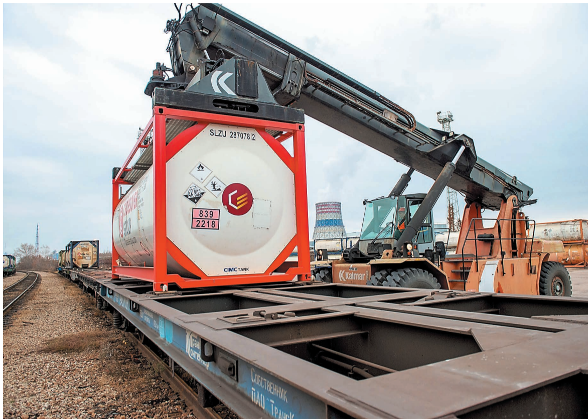
Погрузка-разгрузка с одного вида транспорта на другой производится без перелива продуктов
