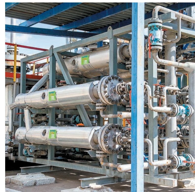
Блок мембранных модулей установки получения окиси углерода и водорода
